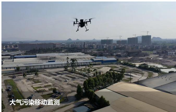
短时间内扫描大面积区域，如居民区、工业园区、建筑工地、交通道路等，同步查看多种污染物的三维浓度分布情况，快速锁定污染源位置与传输方向。适用于常规环境监测、污染源位置排查、环境应急监测等领域。
