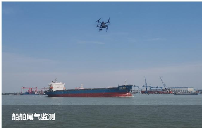
无人机搭载灵嗅飞行至船舶排气烟羽附近（下风区），灵嗅可通过科学先进的数据算法快速反演出该船舶燃料的硫含量预估值，帮助监管机构快速、高效地筛查涉嫌使用硫含量超标燃油的船只。
