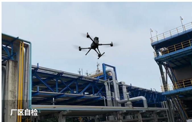
突破地形限制、避免人工攀爬与近距离接触有害气体而带来的风险，三维巡检结果可为企业决策提供有效依据，以满足企业超低排放或纯粹的安全需求。适用于石油化工类、钢铁焦化类、垃圾填埋等可能存在污染气体排放或泄露的企业。
